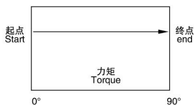
双作用执行器力矩图 Torque diagram double acting actuators
