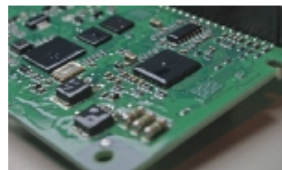
增强型涂层控制板，适合于 IEC60721-3-3 规定的 3C3 类环境，确保恶劣环境下的安全可靠运行。
