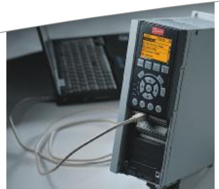
VLT®AutomationDrive可以从外部经过USB电缆或总线通讯进行试运行和监视。有专用软件可以提供：向导 (Wizards)、数据传输工具、VLT设定软件MCT10和语言改变器。
